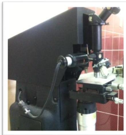
Figura 1. Microdurómetro.
