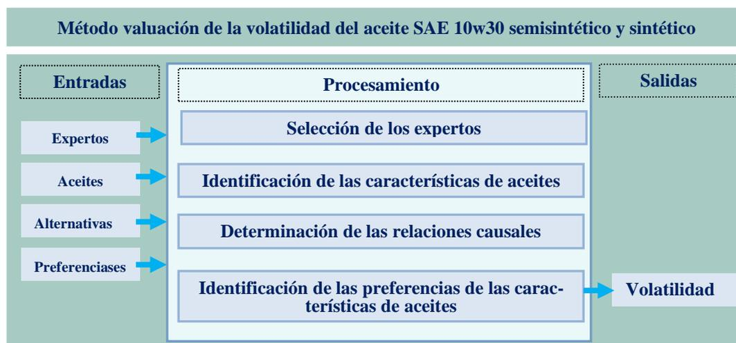
**Figura 1.** Esquema general del funcionamiento del método para la valuación de la volatilidad del aceite SAE 10w30 semisintético y sintético.
