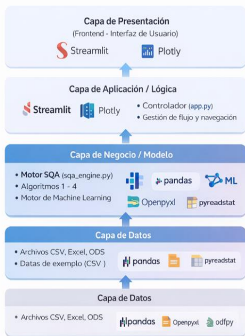
Fig. 1. Arquitectura de la plataforma digital basada en el patrón Modelo–Vista–Controlador (MVC).
